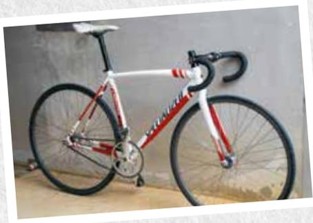
La particularité d'un vélo de piste, c'est qu'il n'a pas de freins. Il est muni d'un pignon fixe. Ça veut dire qu'on ne peut pas s'arrêter de pédaler. Les roues fines, qui ont une meilleure adhérence, permettent d'aller plus vite.
